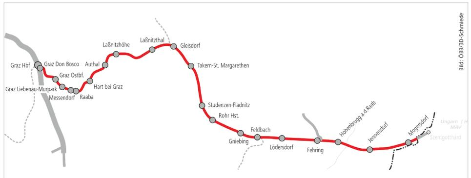
20 Verkehrsstationen und Betriebsstellen auf rd. 80 km Länge umfasst die Strecke von Graz Ostbahnhof nach Mogersdorf. Durch die Elektrifizierung werden kürzere Fahrzeiten und höhere Takte möglich. Ursprünglich in Betrieb genommen wurde die Strecke übrigens 1873 als ungarische Westbahn.
